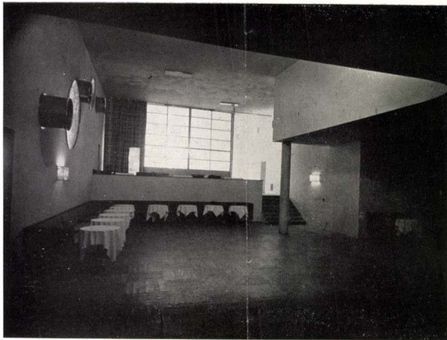
Arch. Lois Welzenbacher: Kitzbühel-i tánc-kávéház. Nézet a galéria felé. A kerek fémtölcsér a légfűtés kiáramlóhelye
